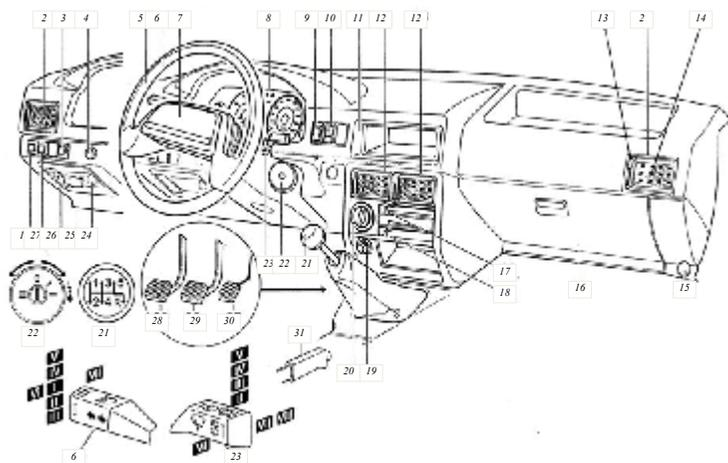
Рис. 25. Составные части передней панели легкового автомобиля
