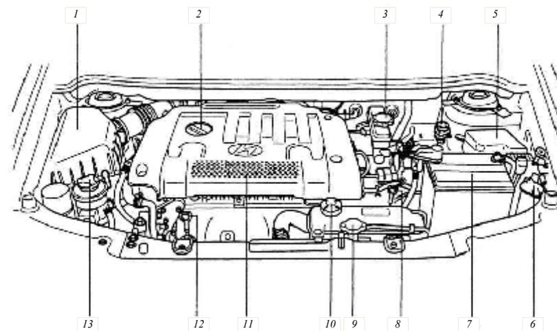
Рис. 26. Составные части легкового автомобиля, расположенные под капотом
