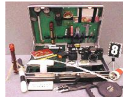
Рис. 2. Унифицированный криминалистический чемодан для осмотра места ДТП «ВД-1»
