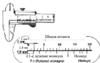
Рис. 19. Шкала штанги и нониус штангенциркуля
