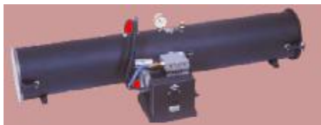
Рис. 6. Вакуумный компрессор и большая камера для окулирования цианоакрилатным эфиром
