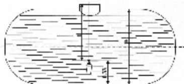
Рис. 3. Схема отбора точечной пробы из цистерны
