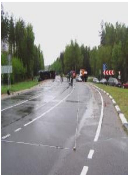
Рис. 2. Построение базовой линии с помощью полотна рулеток
