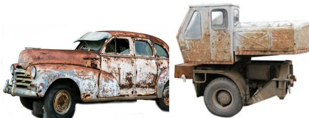
Рисунок 8.5 Коррозия металла ТС или установленного на нем оборудования в процессе эксплуатации.
