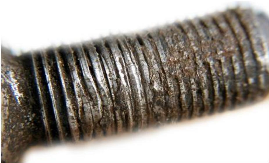
Рисунок 8.7 Вязкое разрушение резьбы на резьбовом пальце рулевого управления.
