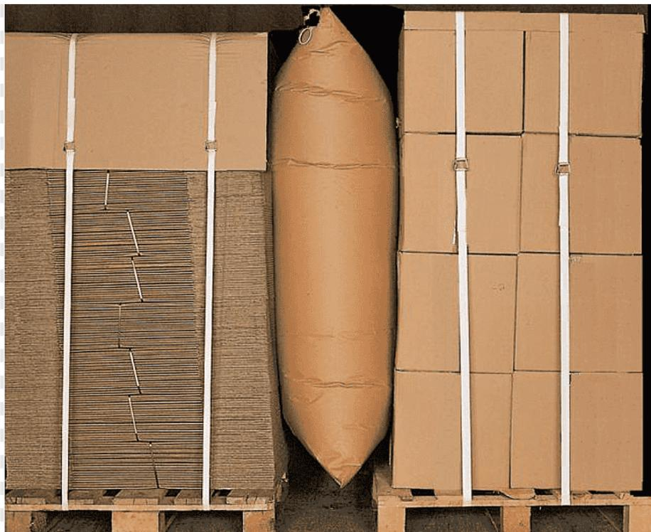
Рисунок 6.5 Применение воздушной подушки для крепления груза.
