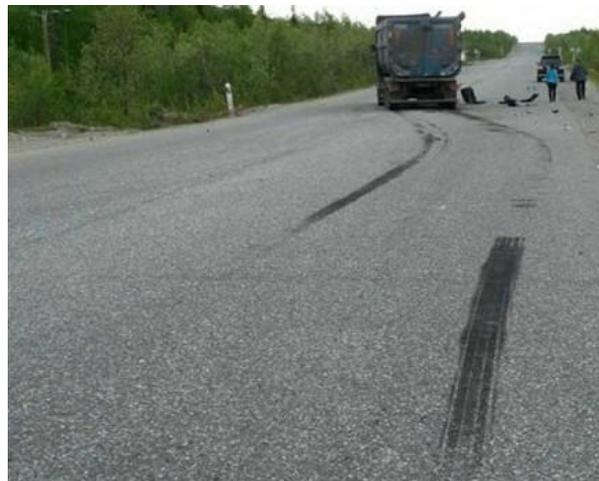
Рисунок 2.9 Следы скольжения шин грузового автомобиля позволяют судить о перераспределении сил между левыми и правыми колесами при изменении траектории движения.
