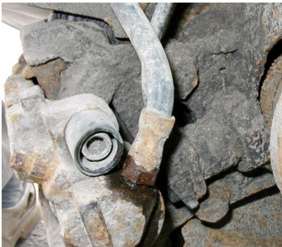
Рисунок 8.12 Нарушение герметичности контура тормозной системы в резьбовом соединении тормозного шланга с колесным тормозным механизмом.
