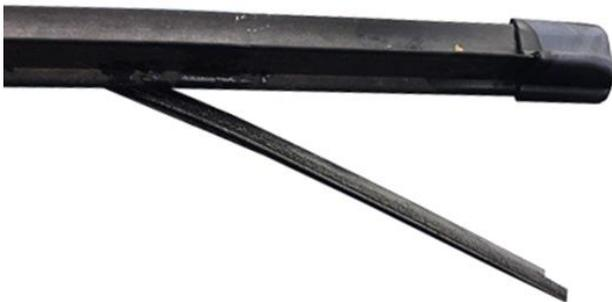
Рисунок 8.3 Обрыв резинового фрагмента щетки стеклоочистителя заднего стекла. Эксплуатационные изменения (повреждение) на ТС в результате старения резины и наличия знакопеременных нагрузок по изгибанию в процессе эксплуатации.
