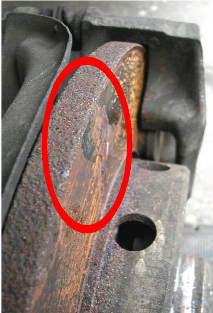
Рисунок 8.6 Коррозия (термическая на торце и атмосферная) тормозного диска в процессе эксплуатации.
