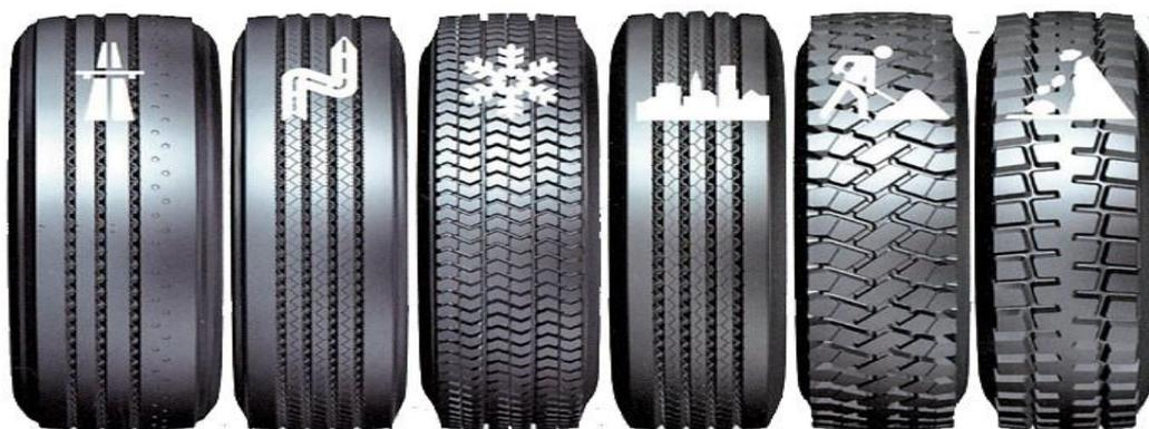
Рисунок 3.4 Вид рисунка протектора легкового автомобиля в зависимости от условий эксплуатации.
