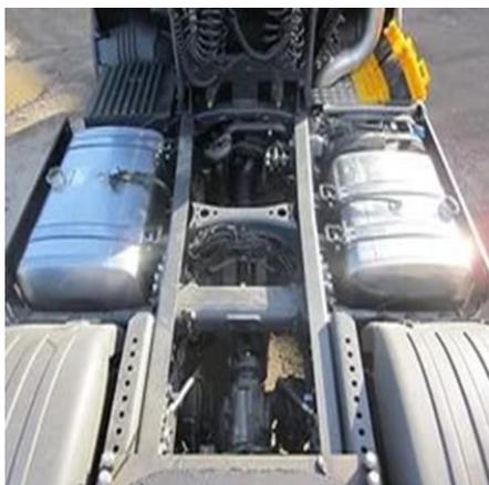
Рисунок 7.1. Дополнительные топливные баки либо основных баки, отличных от топливных баков устанавливаемых предприятием – изготовителем по емкости и размерам, на грузовых автомобилях
