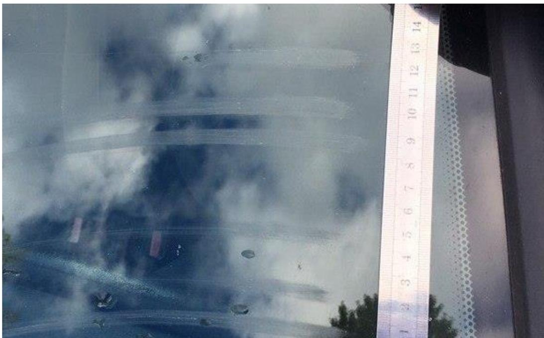
Рисунок 8.4 Абразивный износ на ветровом стекле автомобиля при наличии абразивного материала между стеклом и двигающейся щеткой стеклоочистителя.
