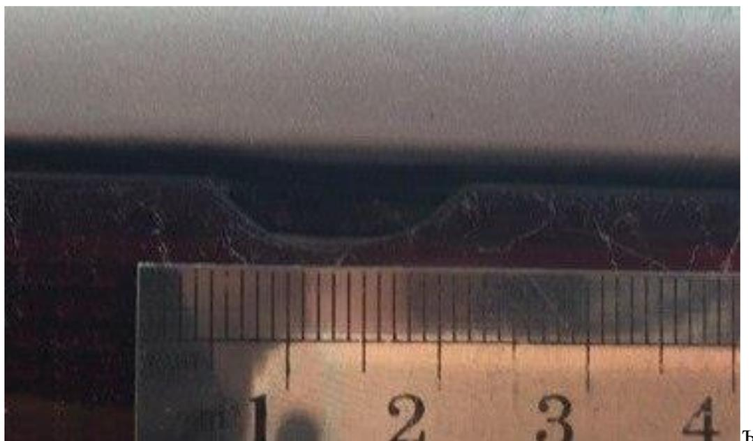
Рисунок 8.9. Хрупкое разрушение кромки фонаря «стоп-сигналов» из пластического материала при его старении
