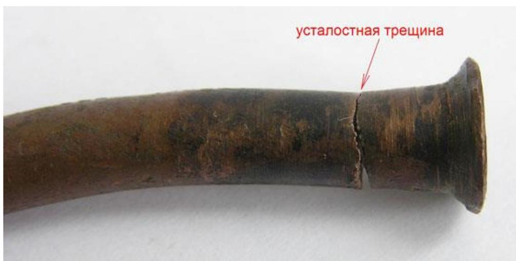
Рисунок 8.11 Усталостное разрушение тормозной трубки
