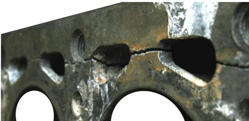
Рисунок 8.8 Хрупкое разрушение блока цилиндров ДВС при его «размораживании» (замерзание охлаждающей воды) в процессе эксплуатации при отрицательной температуре окружающего воздуха
