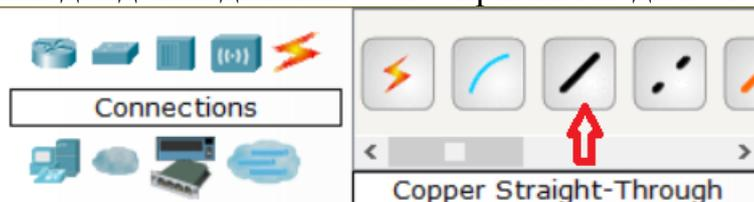
Рис. 6 Выбор соединения с прямым подключением
