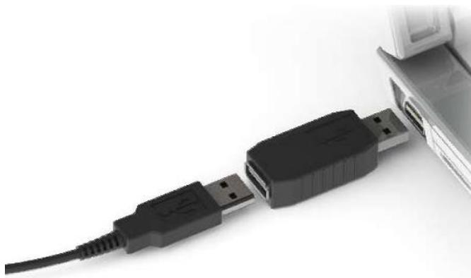
Рис. 8. Аппаратный кейлоггер, встроенный в переходник USB
